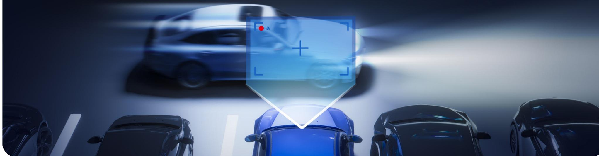
Датчик удара (G-сенсор) реагирует на сильную вибрацию или толчки, и устройство сохраняет видео в отдельную папку
