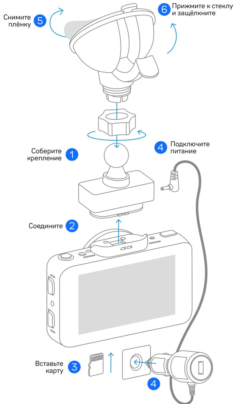
**Для установки устройства на лобовое стекло автомобиля выберите удобный тип крепления: на присоске или двухстороннем скотче.**
