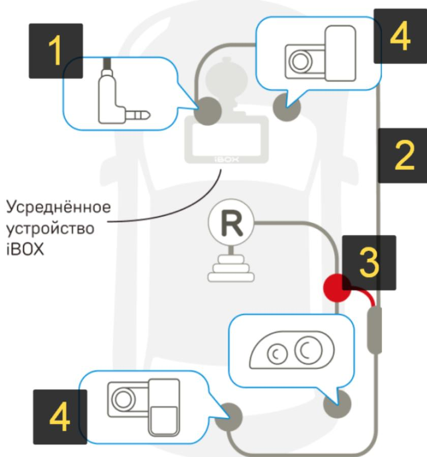
1. Разъём подключения КЗВ к основному устройству iBOX.
