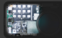
Уникальная комбинация большой патч-антенны и модуля ADR
