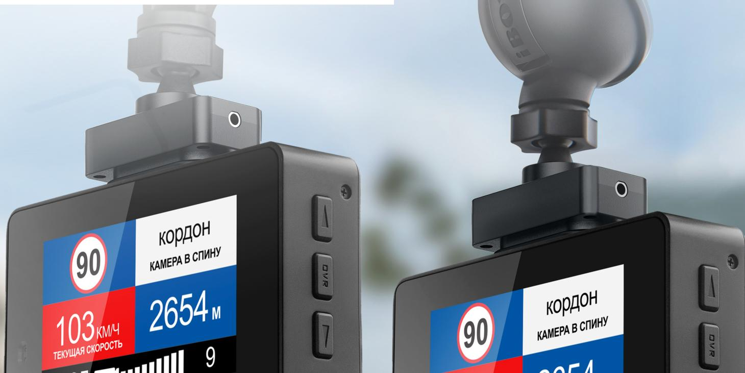
Компактный корпус iBOX iCON LaserVision WiFi Signature S позволяет незаметно установить устройство за зеркалом заднего вида. Для удобства пользователя кабель питания подключается непосредственно в надежное магнитное крепление. Предусмотрено два варианта установки крепления: на 3М скотче или присоске. Такое решение позволяет быстро снимать и устанавливать устройство на лобовое стекло.
