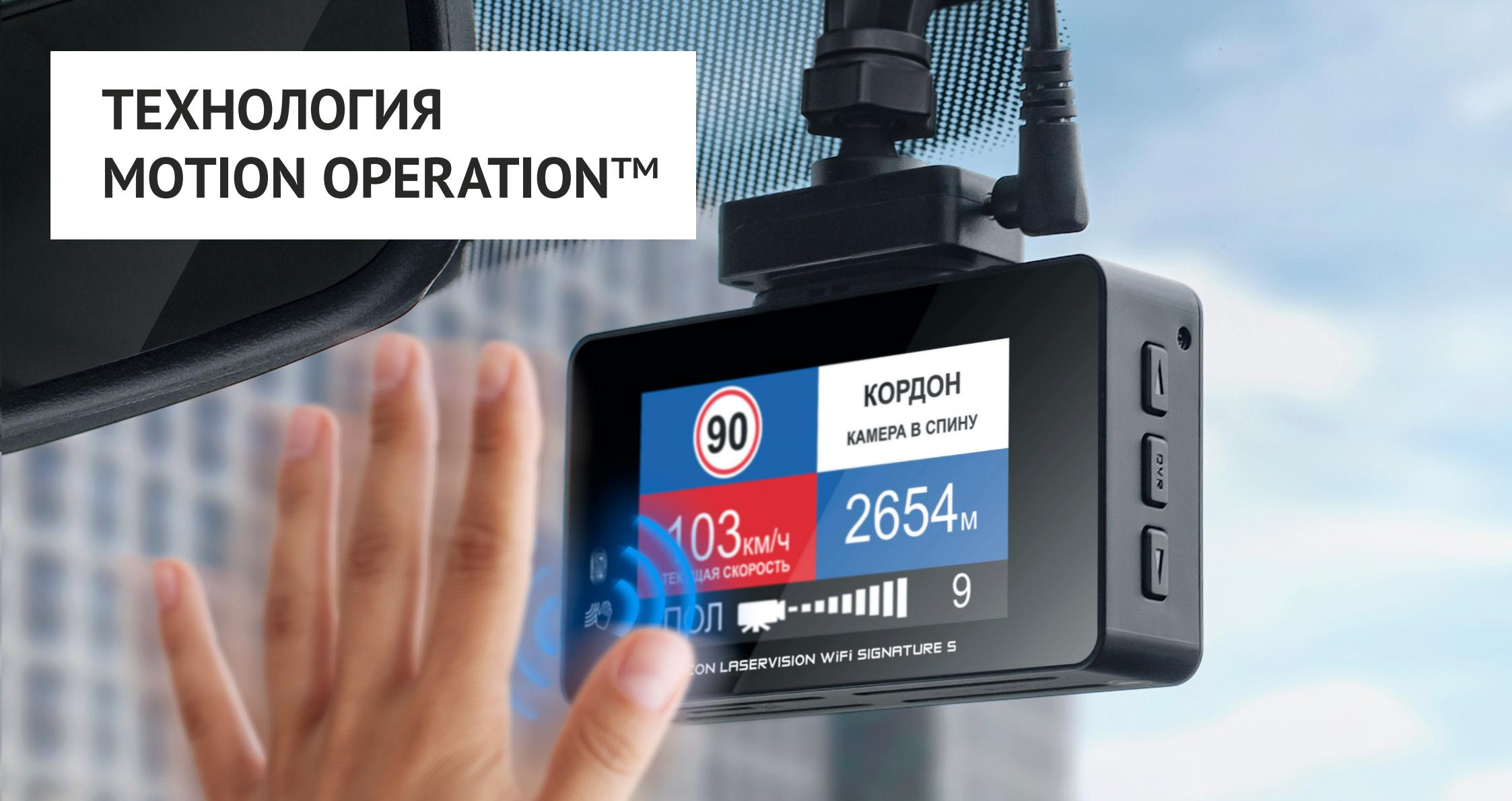
Технология Motion Operation™ позволяет одним движением руки отключить звуковое и голосовое предупреждения при приближении к радару или камере. Пользователю нужно лишь провести рукой перед экраном. Устройство отключит звук и включит только через 6 секунд после окончания оповещения.
