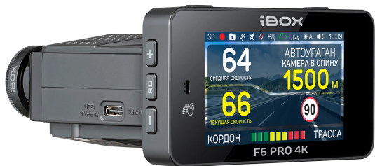
Видеорегистратор со встроенным радар-детектором, крепление с активным питанием
