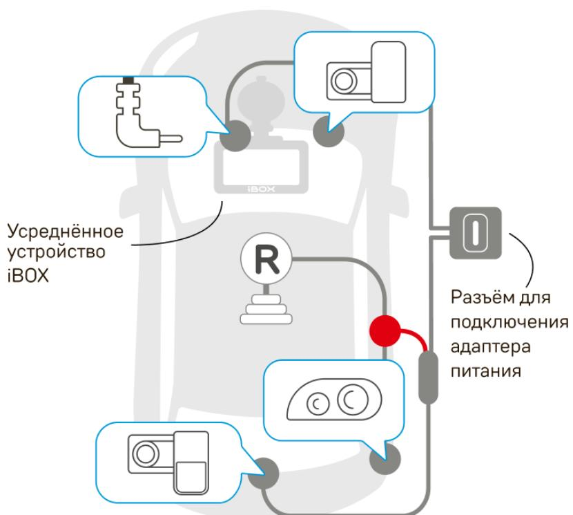
Проложите шнур камеры в салоне автомобиля и подключите его в разъём на устройстве или креплении устройства (в зависимости от модели совместимого устройства). Подключите адаптер питания, идущий в комплекте
