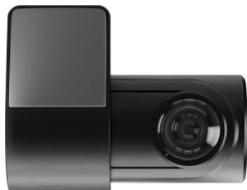
Внутрисалонная камера устанавливается на любое удобное место внутри автомобиля, ведёт съёмку одновременно с фронтальной.
